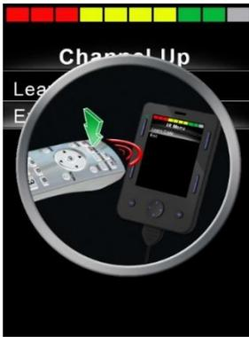
Figura 33 - Pantalla del proceso "Aprender código", a la espera de la transmisión IR del mando.
