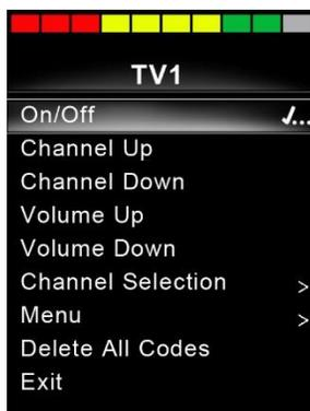
Abbildung 36 – Für den Befehl „On/Off“ (Ein/Aus) wurde eine IR-Folge gespeichert.
