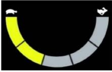
Damit wird die aktuelle Einstellung für die Höchstgeschwindigkeit angezeigt. Siehe Position (F) in Abbildung 3.
