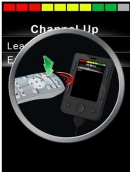
Abbildung 33 – Anzeige für den Prozess „Learn Code“ (Code lernen), wartet auf die IR-Übertragung von der Fernbedienung.
